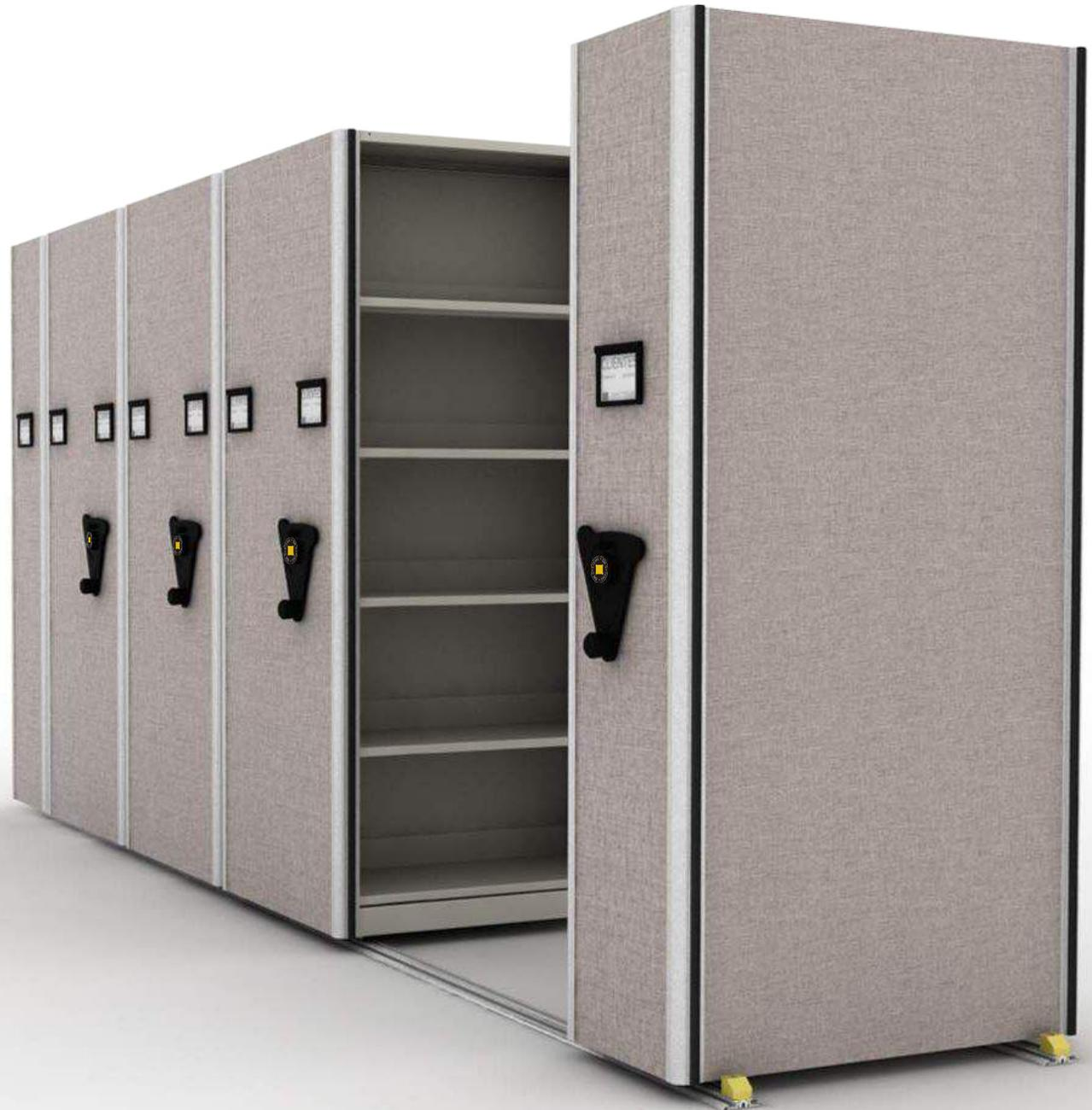
Los módulos deslizantes DH SYSTEMS se desplazan mediante un sistema de tracción sobre rieles colocados en el piso. El sistema, en general está compuesto por un módulo fijo simple (MFS) en un extremo, luego módulos deslizantes dobles (MDD) para aprovechar ambos lados para carga y finalizan en un módulo deslizante simple (MDS), o en un módulo deslizante doble con puerta. Éste conjunto lo denominamos "Batería".
